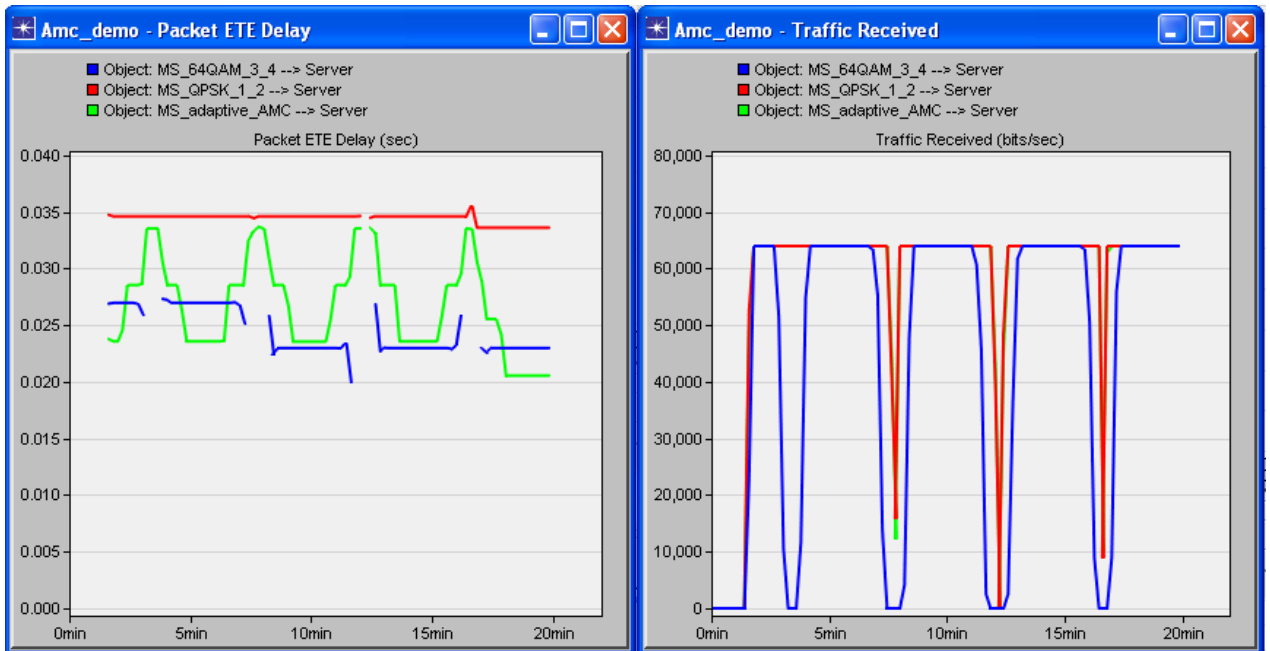
Σχήμα 37: Αποτελέσματα Delay και Traffic Received για διαφορετικές τιμές του Modulation and coding όπως φαίνονται στον Πίνακα 10.
