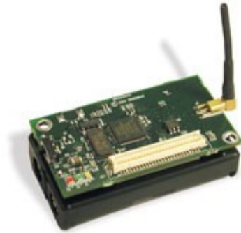
Σχήμα 2.17: MicaZ Wireless Module [9]
