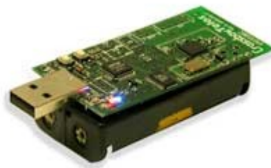
Σχήμα 2.18: TelosB Wireless Module [9]
