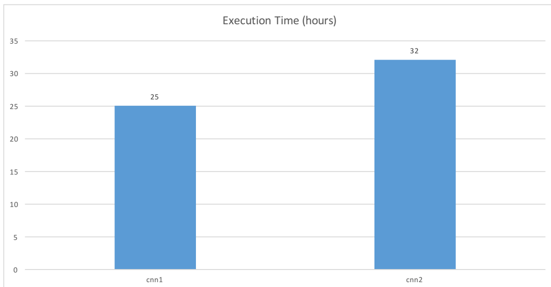
Γραφική Παράσταση 6.30: Απαιτούμενος χρόνος εκπαίδευσης για κάθε νευρωνικό δίκτυο με χρήση της μεθόδου κατάβασης κλίσης (cnn1) και της μεθόδου conjugate gradient (cnn2).
