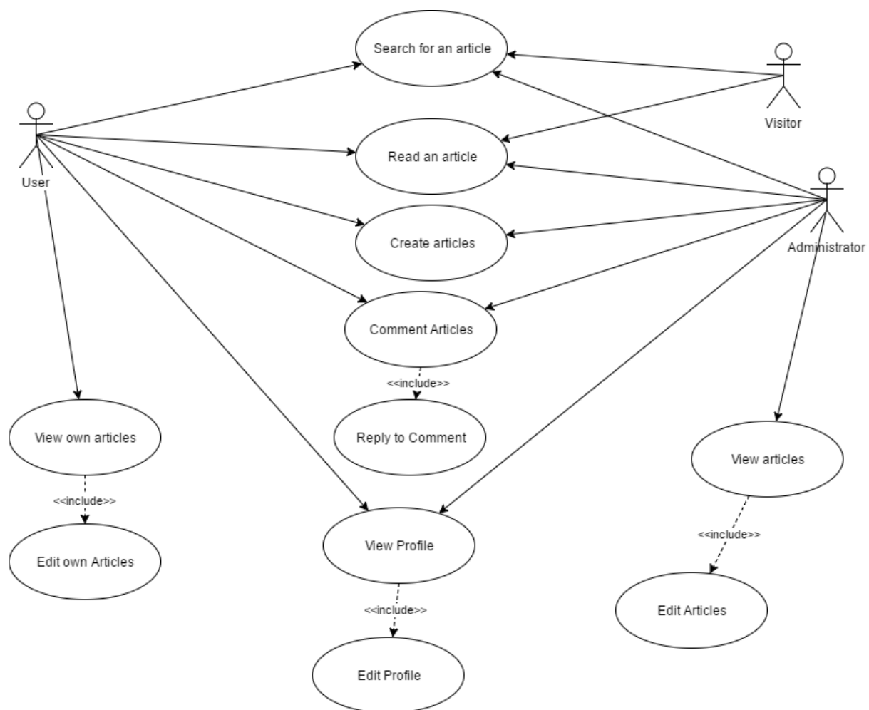
Σχήμα 3.1 Διάγραμμα Περιπτώσεων Χρήσης: Παρουσίαση των λειτουργιών του χρήστη ανάλογα με το είδος του.
