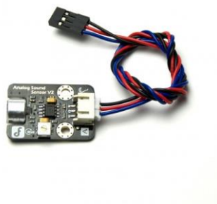
Εικόνα 3.11 Αισθητήρας Ήχου DFR0034
