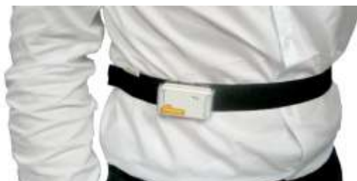
Σχήμα 3.4 : Ζώνη-Ιμάντας που εφαρμόζει στο στήθος με μονή βάση για τοποθέτηση του Shimmer2R [12]
