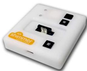
Σχήμα 3.3 : Συσκευή Dock για φόρτιση αλλά και ένωση του Shimmer2R με τον Shimmer2R [12]
