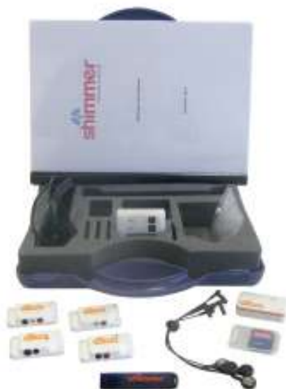
Σχήμα 3.1 : Βαλίτσα-Θήκη της Shimmer που περιέχει 3 μοντέλα Shimmer2R, 2 docks, καλώδιο ένωσης dock με υπολογιστή, 12 βεντούζες, usb stick, user manual και ζώνη-ιμάντα που εφαρμόζει στο στήθος [12]
