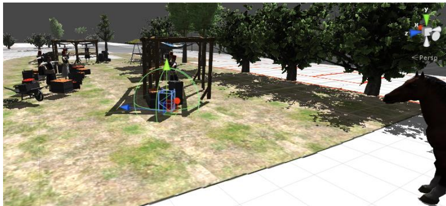
Σχήμα 5.4.2: Sphere Collider στο βαρέλι στην αγορά.
