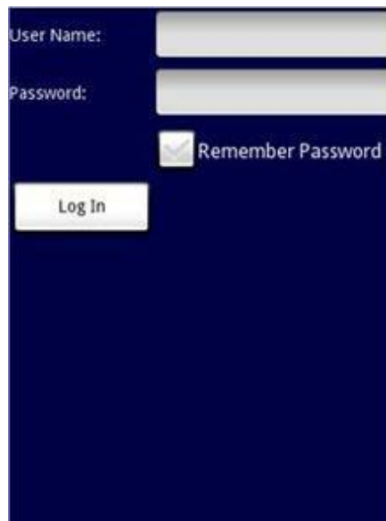
Εικόνα 3.5: Παράδειγμα κατασκευής ενός TableLayout το οποίο ζητάει όνομα χρήστη και κωδικό πρόσβασης
