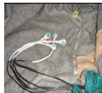
Σχήμα 3.20 (δεξιά) Εσωτερική όψη του E-Jacket με τον αισθητήρα θερμοκρασίας και τα ECG ηλεκτρόδια [52]
