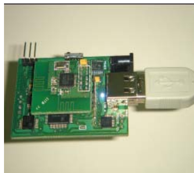
Σχήμα 3.22 Ασύρματος πομποδέκτης (transceiver) με USB θύρα για τον κεντρικό Η/Υ [52]
