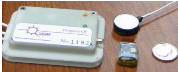
Σχήμα 3.29 QUASAR ECG αισθητήρες, Eco ασύρματος αισθητήρας και ένα νόμισμα [42]
