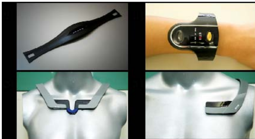
Σχήμα 3.28 Τέσσερις τύποι φορητής συσκευής για παρακολούθηση του ECG α) Ζώνη στο στήθος, β) Ρολόι χειρός, γ) Κολιέ, δ) Ωμος
