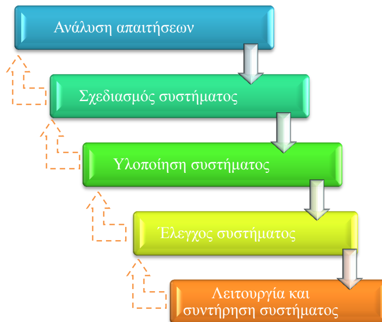
Σχήμα 4.1: Διαδικασίες και στάδια προτύπου ανάπτυξης συστήματος, Καταρράκτη
