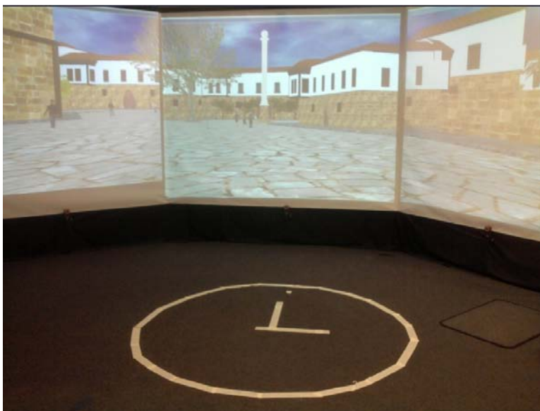
Σχήμα 1.2: Προβολή προσομοιωτή σε 3 επιφάνειες προβολής και σε χώρο με δυνατότητα κίνησης
