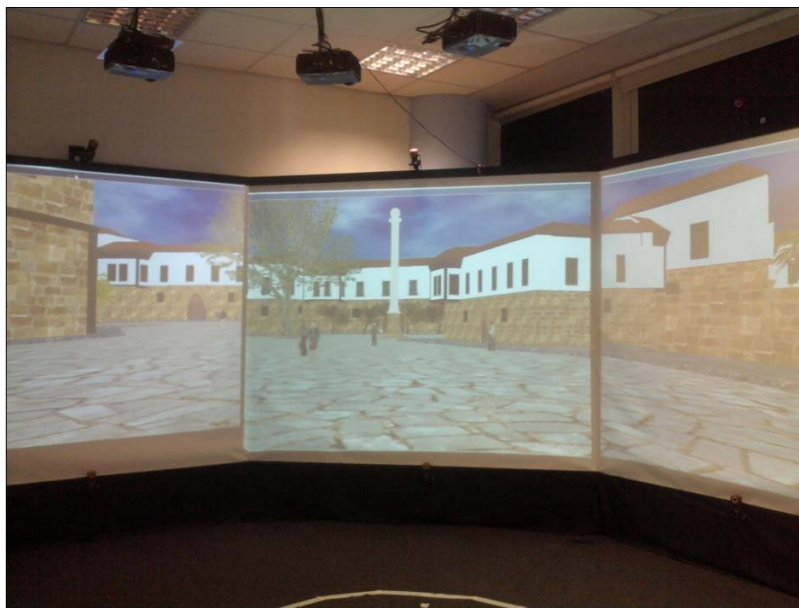
Σχήμα 4.12: Χώρος με το σύστημα Motion Tracking, προβολή του προσομοιωτή σε τρεις οθόνες με χρήση τριών προβολέων
