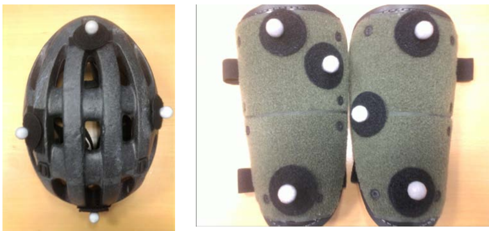
Σχήμα 4.15: Αριστερά: Rigid Body – Head, Δεξιά: Rigid Body – Left Leg, Right Leg
