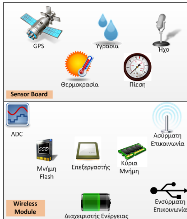
Εικόνα 3: Αρχιτεκτονική Συσκευής Ασύρματου Αισθητήρα
