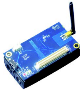
Εικόνα 15: Connector (με άσπρο χρώμα) του επεξεργαστή IRIS M2110 με μπαταριοθήκη
