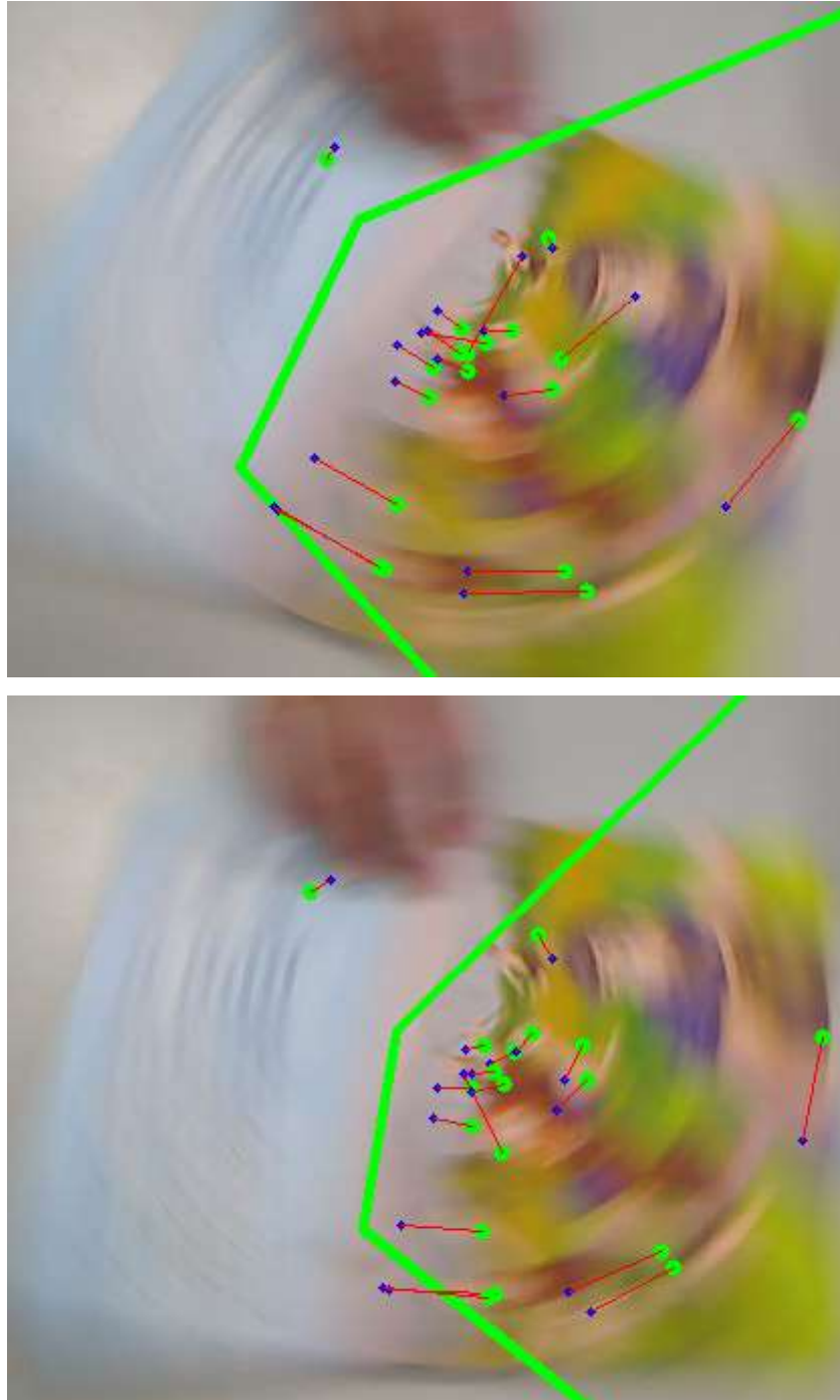
Σχήμα 8.3 Ανίχνευση οπτικής ροής σε γρήγορη κίνηση. Δύο διαδοχικές εικόνες στις οποίες τα σημεία που είναι σημειωμένα με πράσινο δείχνουν τη θέση του σημείου στο προηγούμενο frame και με μπλε χρώμα τη θέση που ανιχνεύτηκε στο νέο frame. Συνέχεια διαδοχικών frames στο Σχήμα 8.4.
