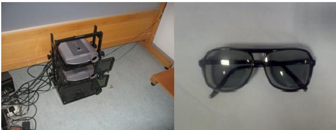
Σχήμα 4.12: Αριστερά: Projector με αντίθετα πολωμένα φίλτρα Δεξιά: Γυαλιά με αντίθετα πολωμένα φίλτρα
