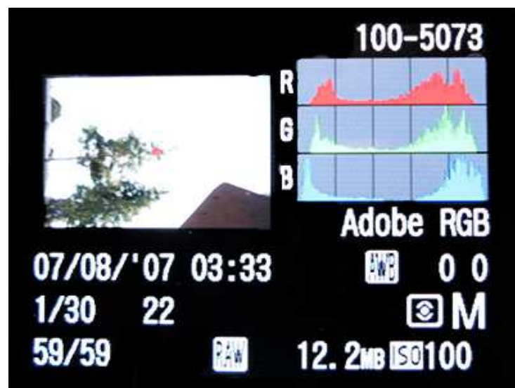
Σχήμα 4.2: RGB ιστογράμματα σε ψηφιακές βιντεοκάμερες
