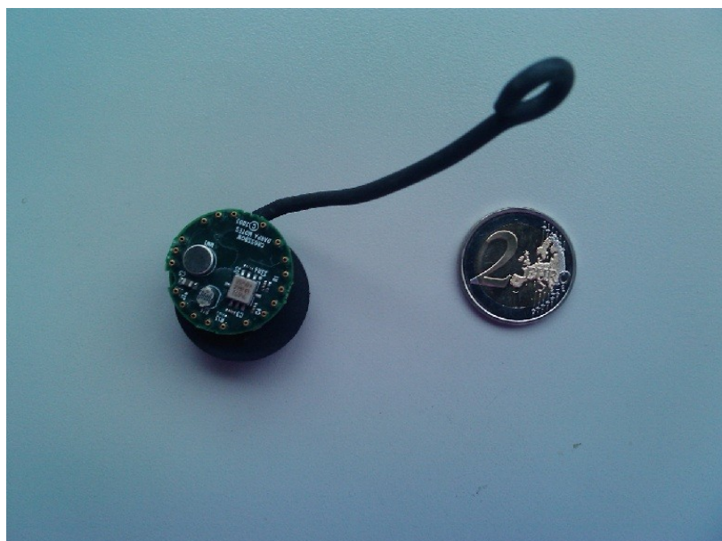
Σχήμα 1.1: Κόμβος αισθητήρα Mica2dot σε σχέση με νόμισμα δύο Ευρώ
