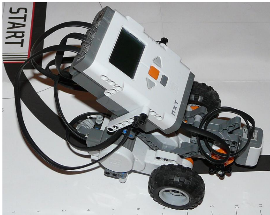
Σχήμα 4.6: Ακολουθία γραμμής από το Lego NXT με τη χρήση ενός αισθητήρα φωτός
