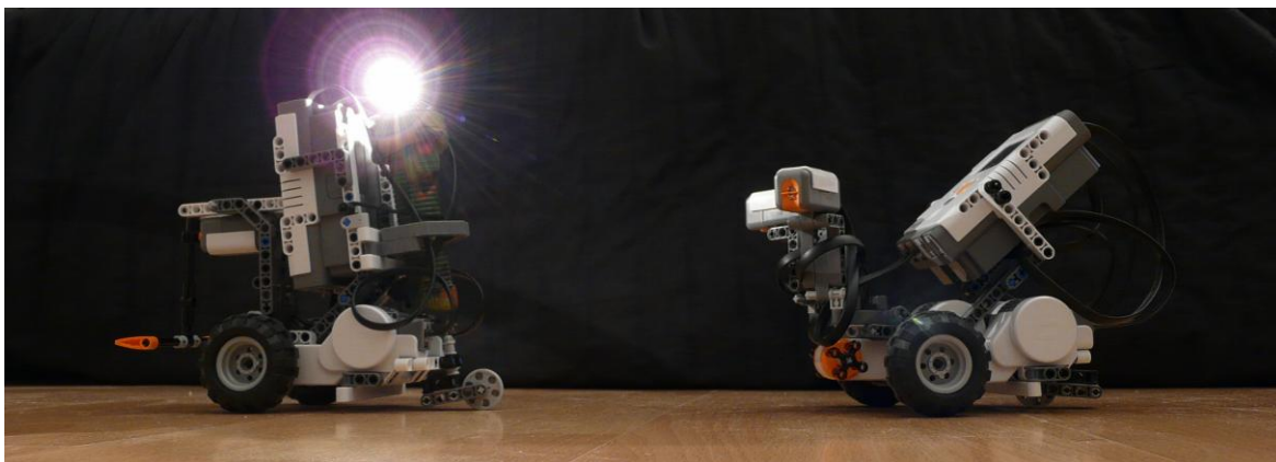
Σχήμα 4.21: Εφαρμογή εντοπισμού φωτεινού στόχου από το ρομπότ
