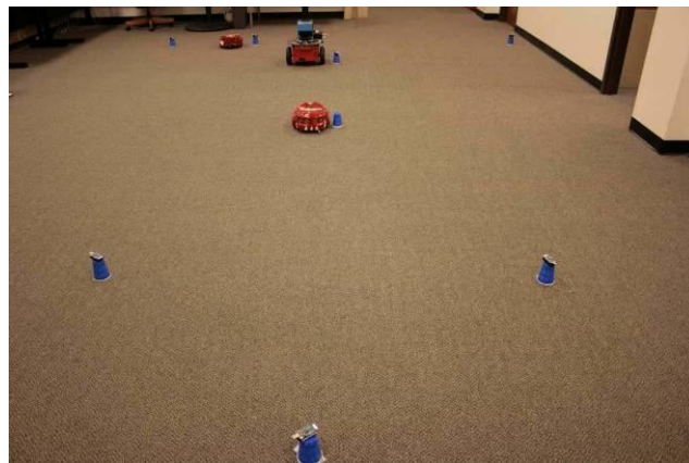
Σχήμα 7.6: Συνεργασία AmigoBot και Pioneer P3-DX για επιδιόρθωση συνδεσιμότητας [6]
