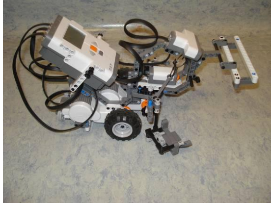
Σχήμα 6.1: Το NXT robot διαμορφωμένο για να χρησιμοποιηθεί ως πλατφόρμα μεταφοράς κόμβων αισθητήρων
