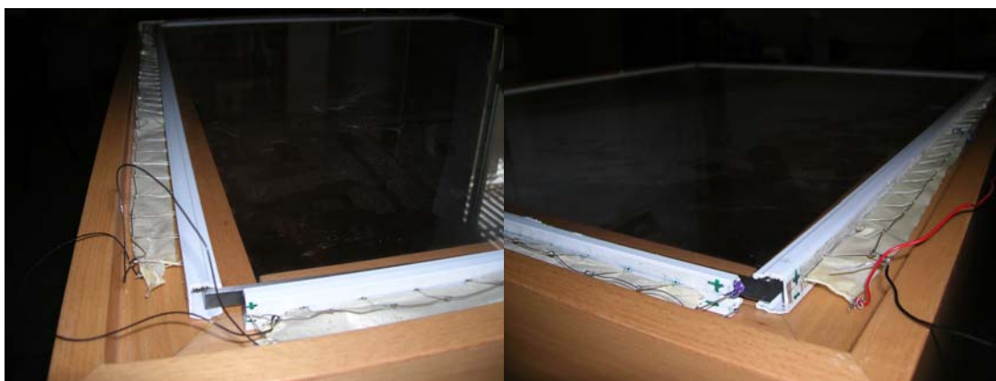
Σχήμα 6.17 Το τελικό αποτέλεσμα για τα LEDs στη μέθοδο FTIR
