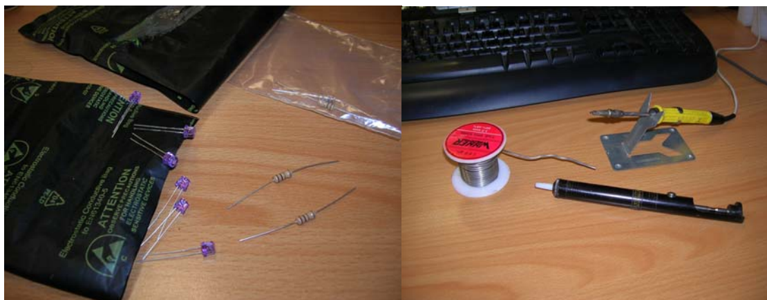
Σχήμα 6.15 Κύρια υλικά και εργαλεία για υλοποίηση του τμήματος των LEDs
