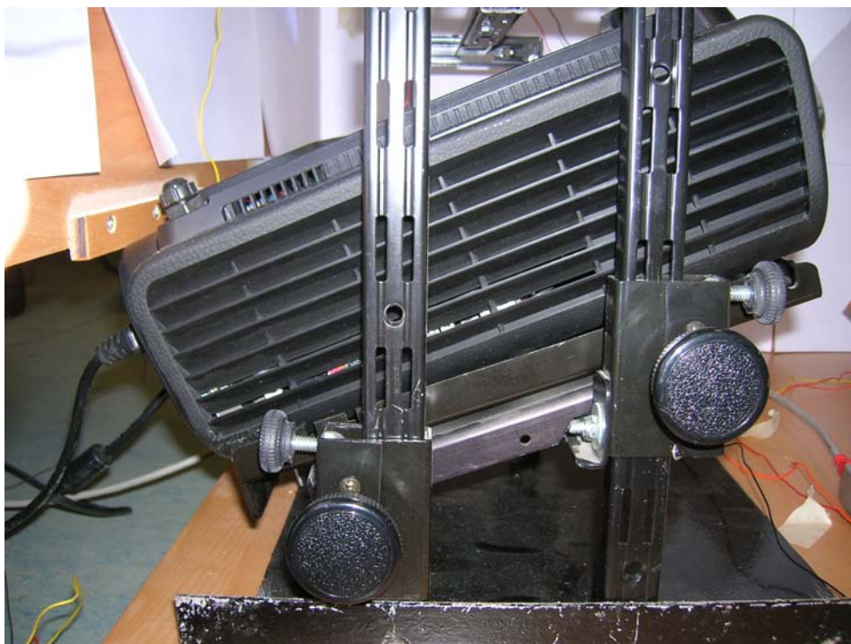
Σχήμα 6.12 Ο μηχανισμός μετακίνησης του projector από το πλάι
