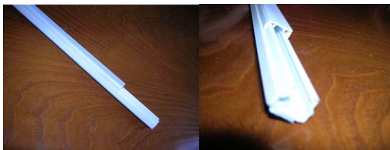
Σχήμα 6.16 Ο οδηγός καλωδίων που χρησιμοποιήθηκε ως πλαίσιο
