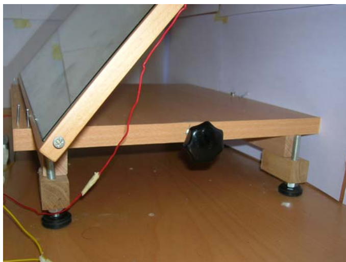
Σχήμα 6.14 Ο μηχανισμός μετακίνησης του καθρέφτη
