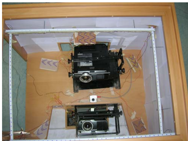
Σχήμα 6.21 Το τελικό αποτέλεσμα για τα LEDs στη μέθοδο Rear DI
