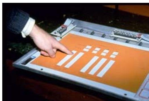
Σχήμα 2.4 Το multi-touch tablet από το Πανεπιστήμιο του Τορόντο
