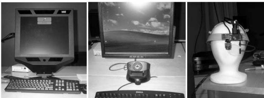
α) β) γ) Σχήμα 3.1.1. Συσκευές Eye tracking, a) Tobii 1750 b) ASL 504 Pan/Tilt Optics c) ASL 501 Head Mounted
