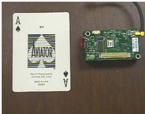
Σχήμα 2.2 Μέγεθος τυπικού Αισθητήρα
