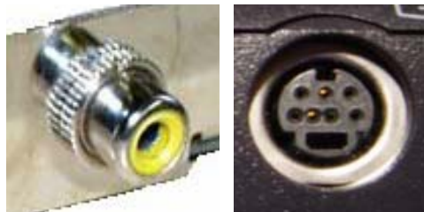
Εικόνα 2.2 – Αριστερά βλέπουμε το composite input και δεξιά το s-video input [6].
