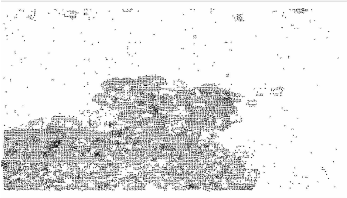
Σχήμα 6.30 Γραφική αναπαράσταση οπτικής ροής με κατωφλίωση 1.5
