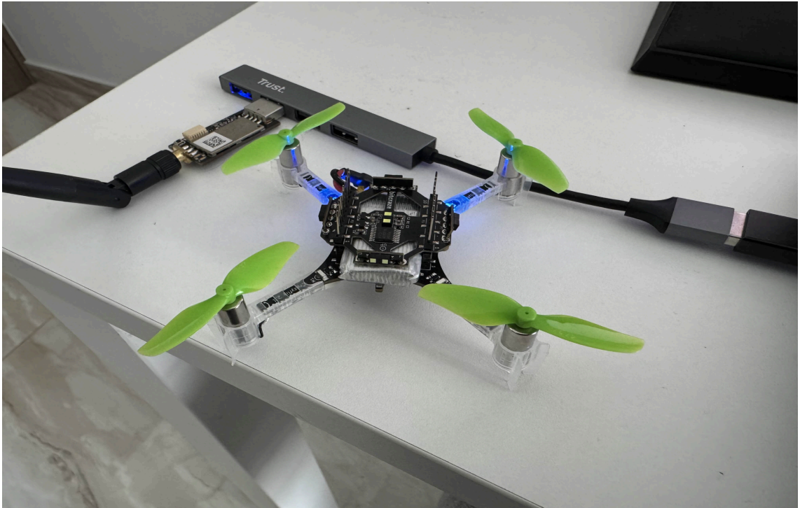
Εικόνα 2.13 Crazyflie με συνδεδεμένο το Multi-Ranger Deck από πάνω
