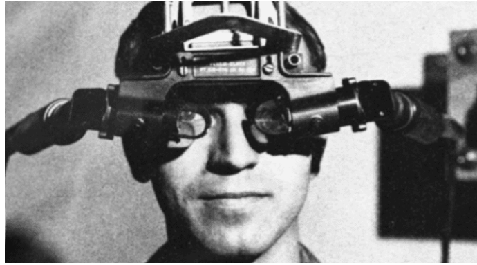
Εικόνα 2.1: Η πρώτη συσκευή HMD όπως επινοήθηκε από τον καθηγητή Ivan Sutherland στο Πανεπιστήμιο της Utah σε συνεργασία με τους φοιτητές του.
