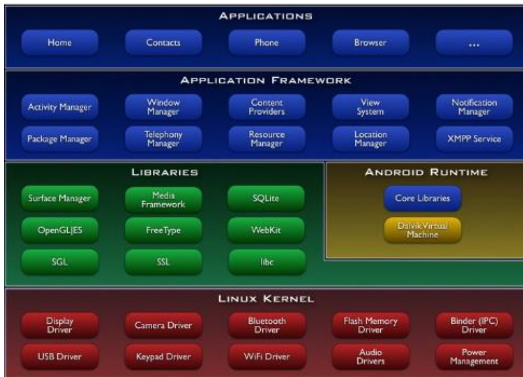
Διάγραμμα 3.1 Android Software Stack[22]
