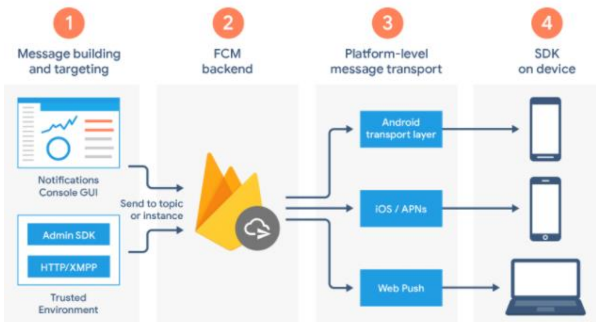
Εικόνα 2.3 Κύκλος ζωής της αποστολής μιας ειδοποίησης μέσω Firebase [7]
