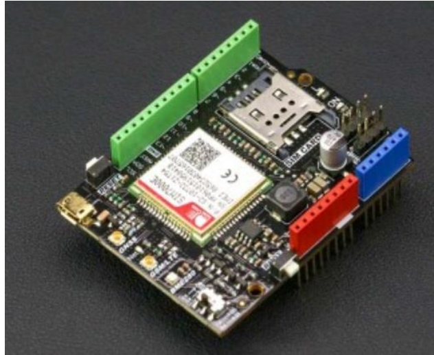
Σχήμα 4.2: Sim7000E Arduino NB-IoT/LTE/GPRS expansion shield
