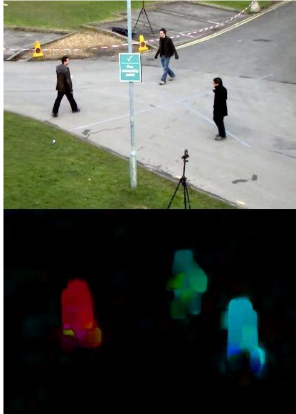
Εικόνα 3.3.2.3 (α) Παράδειγμα εκτίμησης της οπτικής ροής μέσω του αλγορίθμου του Farneback [12]
