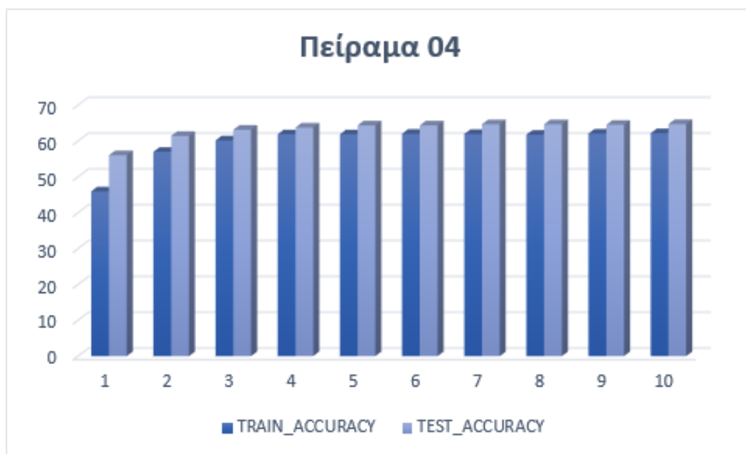
Σχήμα6.2.4.1: Αναπαράσταση του Accuracy του δικτύου σε κάθε εποχή κατά την εκπαίδευση και τον έλεγχο του δικτύου σύμφωνα με τα δεδομένα του σχήματος. Στον οριζόντιο άξονα αναπαριστάται η εποχή και στον κάθετο άξονα το ποσοστό επιτυχίας.
