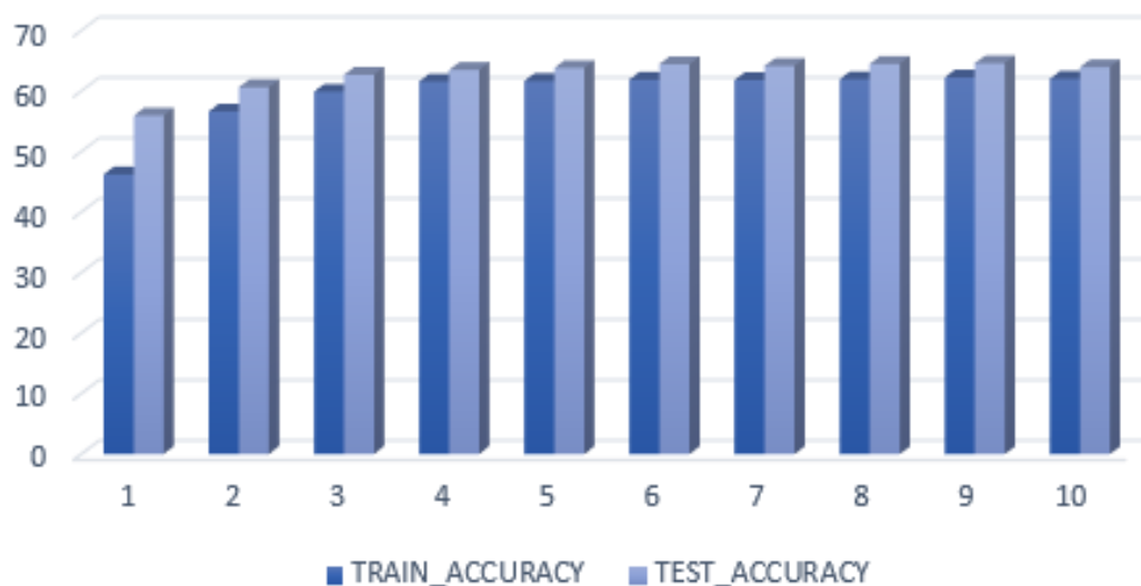
Σχήμα 6.2.3.1: Αναπαράσταση του Accuracy του δικτύου σε κάθε εποχή κατά την εκπαίδευση και τον έλεγχο του δικτύου σύμφωνα με τα δεδομένα του σχήματος. Στον οριζόντιο άξονα αναπαριστάται η εποχή και στον κάθετο άξονα το ποσοστό επιτυχίας.
