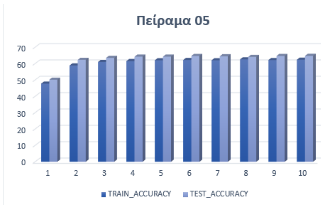
Σχήμα 6.2.5.1: Αναπαράσταση του Accuracy του δικτύου σε κάθε εποχή κατά την εκπαίδευση και τον έλεγχο του δικτύου σύμφωνα με τα δεδομένα του σχήματος. Στον οριζόντιο άξονα αναπαριστάται η εποχή και στον κάθετο άξονα το ποσοστό επιτυχίας.
