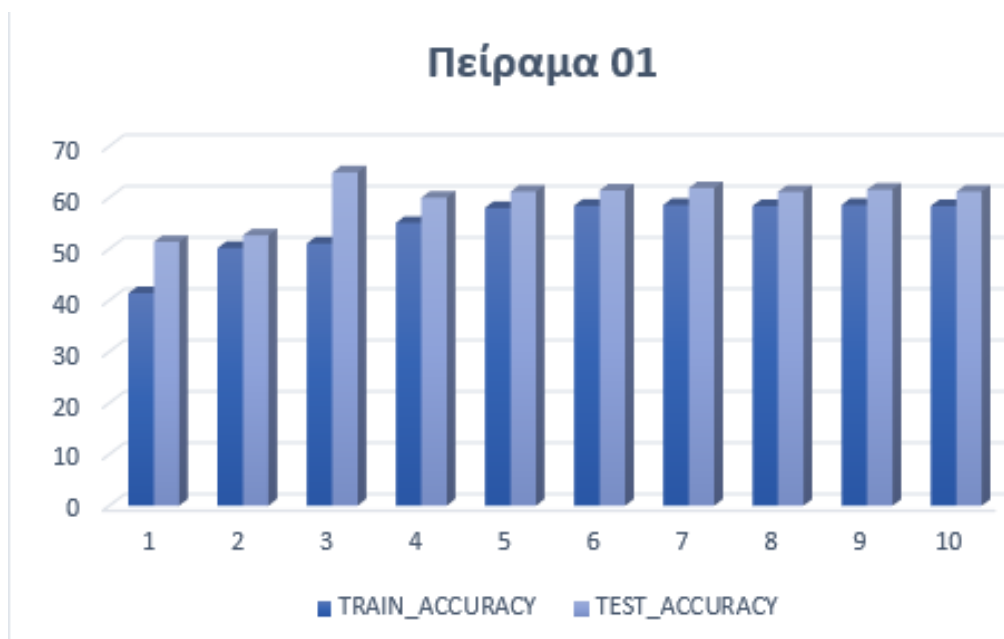
Σχήμα 6.2.1.1: Αναπαράσταση του Accuracy του δικτύου σε κάθε εποχή κατά την εκπαίδευση και τον έλεγχο του δικτύου σύμφωνα με τα δεδομένα του σχήματος. Στον οριζόντιο άξονα αναπαριστάται η εποχή και στον κάθετο άξονα το ποσοστό επιτυχίας.
