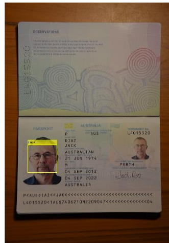
Σχήμα 7.7 Το αποτέλεσμα της εφαρμογής του αλγορίθμου Viola-Jones που όπως παρατηρούμε εντοπίζει το πρόσωπο με μεγάλη ακρίβεια και σχηματίζει ένα ορθογώνιο γύρο από αυτό.
