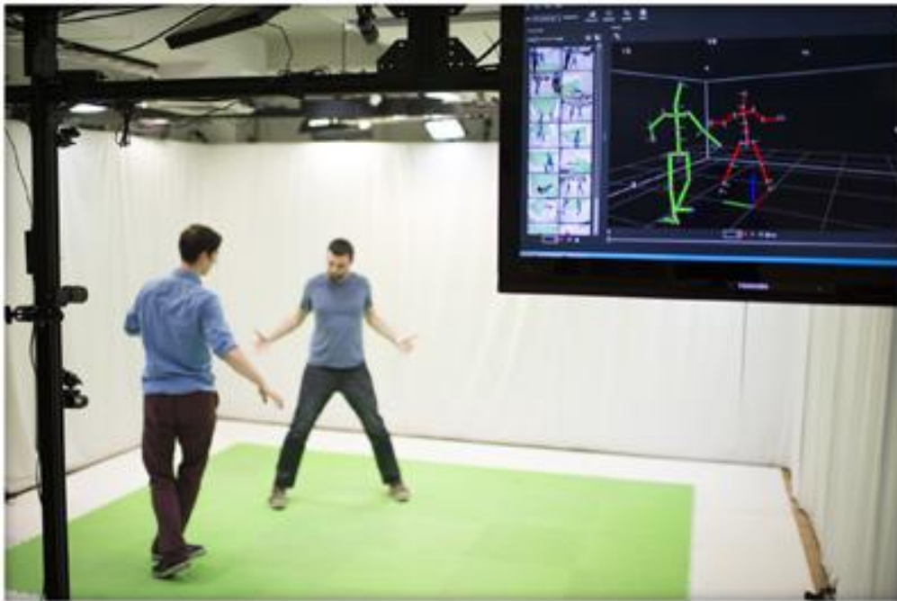
Εικόνα 2.2 Markerless σύστημα ανάγνωσης κίνησης
