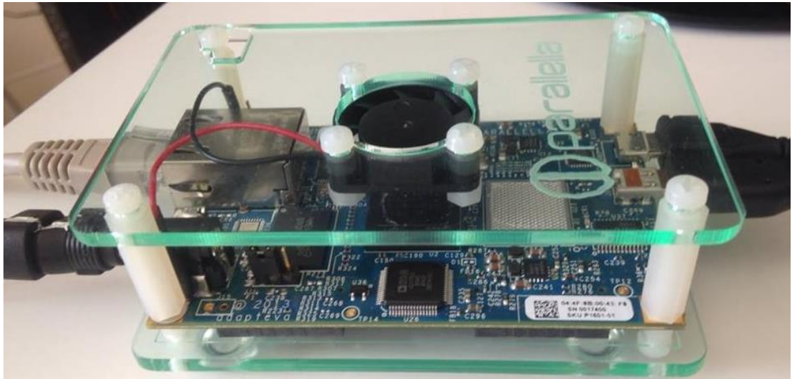
Εικόνα 17: Η ψήκτρα (fan) τοποθετημένη στο board.
